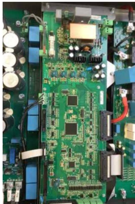
▲ Ein defektes Controlboard von einem der Wechselrichter in Wachenbrunn
